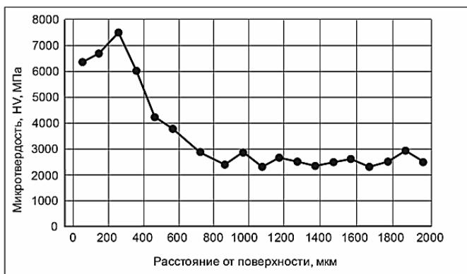
Рис. 2. Распределение микротвердости наплавленного высокоуглеродистого слоя
