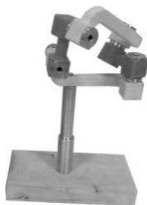
Рис. 4. Изготовленная модель 4R механизма методом 3D печати
