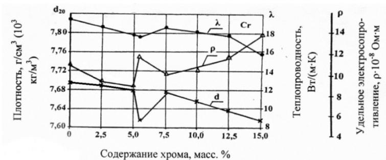
Рис. 1. Зависимость физических свойств белого чугуна от содержания хрома
