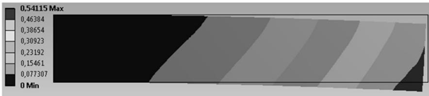
Деформации закаленного стержня (мм)
